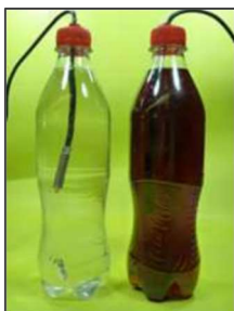
Bouteilles tests avec boisson gazeuse incolore et de couleur foncée. Sondes de température installées et scellées
