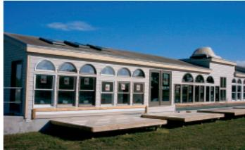
In unserer **Freibewitterungsstation in Florida/USA** werden Kunststoff-Fenster-rahmen in speziellen Testhäusern geprüft. Hiermit erreichen Sie eine Simulation unter realistischen Bedingungen inklusive des Einflusses der Albedostrahlung.
