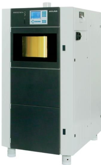
Das Bewitterungsprüfgerät **Xenotest Beta** mit seinem kompakten Design kann durch eine Vielzahl an optionalen Merkmalen praktisch alle weltweiten Anforderungen an Bewitterungsprüfungen erfüllen, so zum Beispiel auch Prüfnormen wie RAL-GZ 716/1 Abschnitt I+II, EN 513 oder ISO 4892-2.
